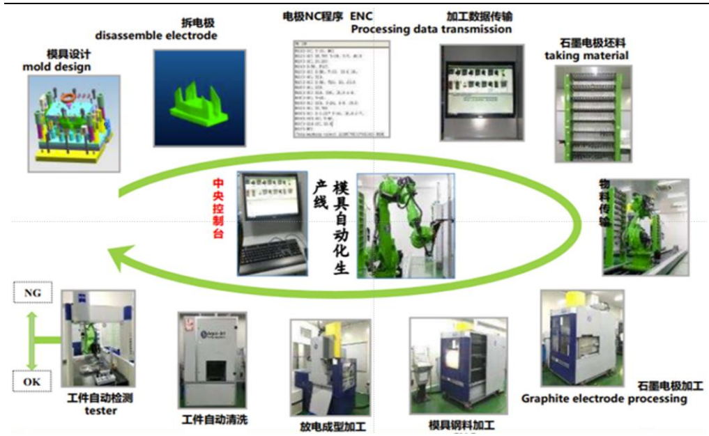
图44: 公司具备模具设计加工检测的自动化体系
