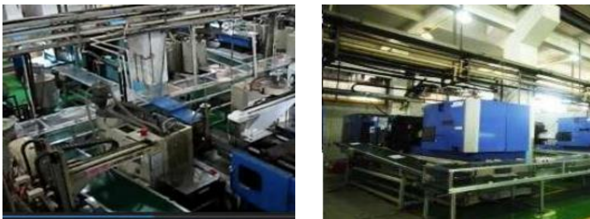
图45: 注塑车间实施全自动集中化加工管理
