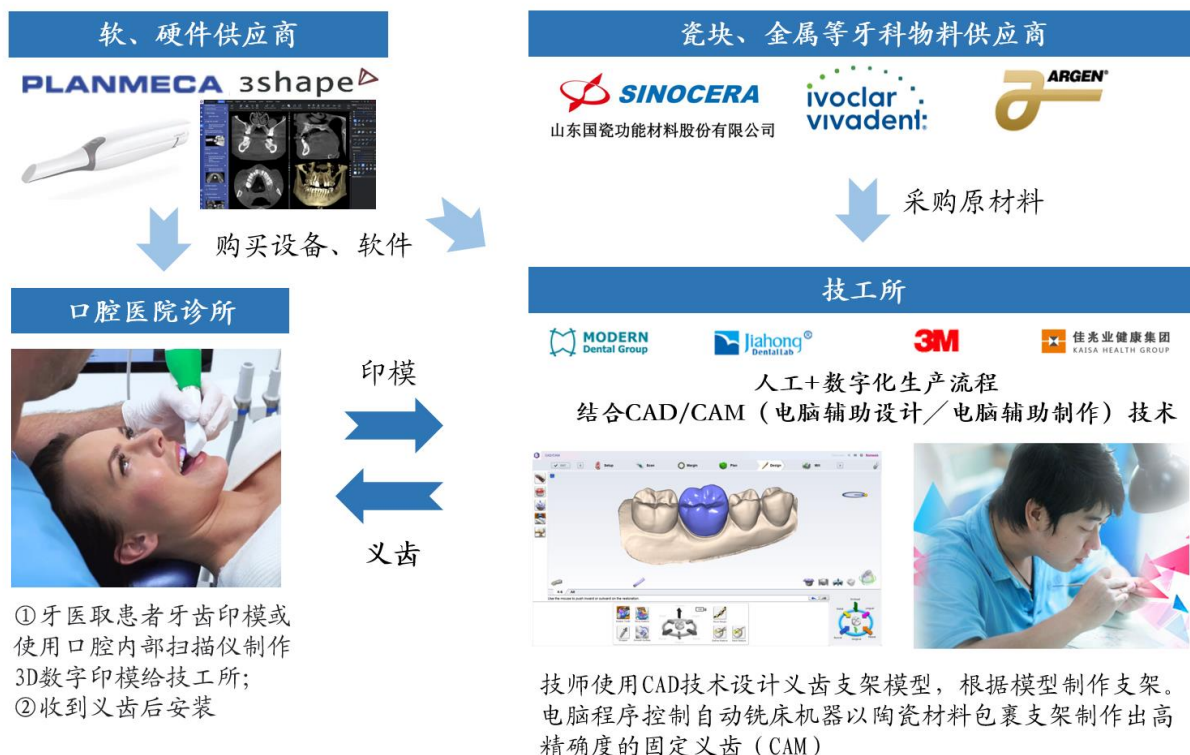
图 26: 固定义齿的生产流程
